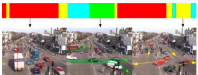
Identification automatique des flux de circulation
