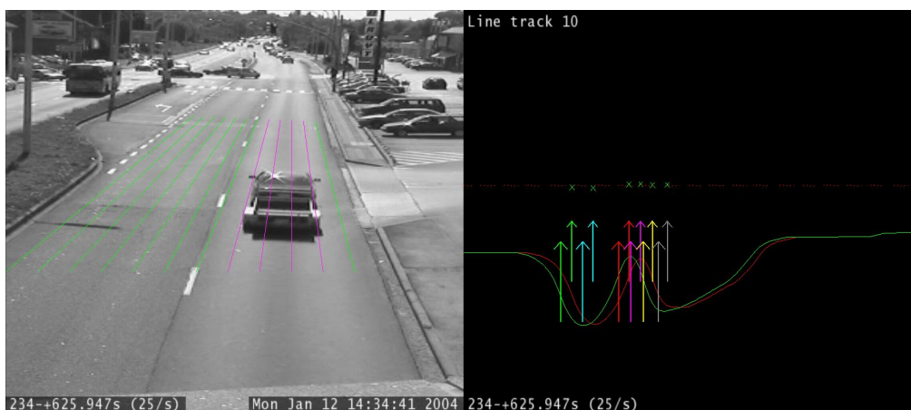
Figure 7: Mise en correspondance des caractéristiques de deux profils consécutifs
