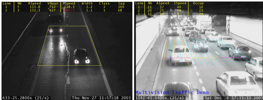
Figure 11: Traitement de nuit et en tunnel
