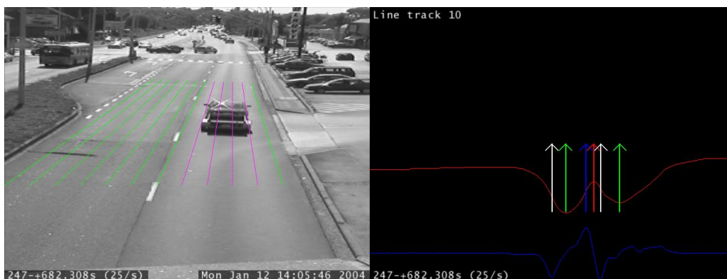
Figure 6: Sélection de caractéristique sur un profil: maxima, minima et points d'inflexion
