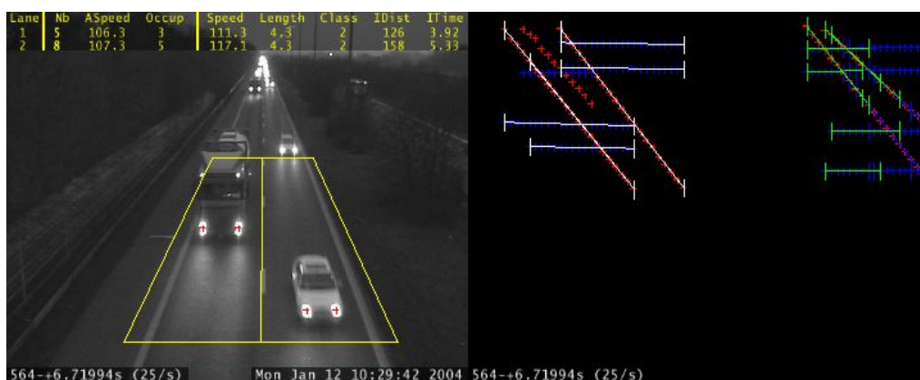
Figure 8: Segmentation des phares et extraction des trajectoires
