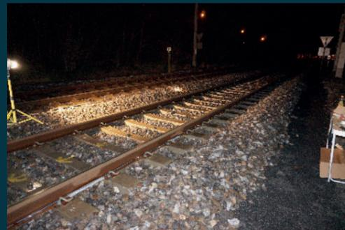
Capteurs optiques de surveillance des déformations du rail
