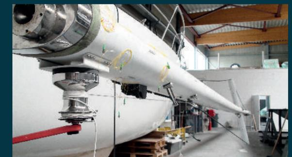
Surveillance de contraintes de structure d'un mât de bateau
